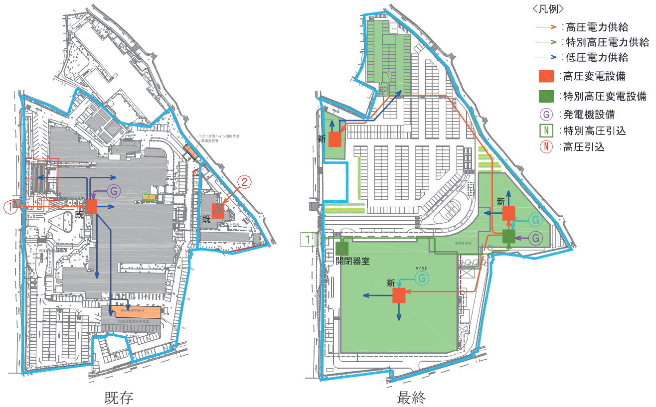
図1 電力引込ルート図
